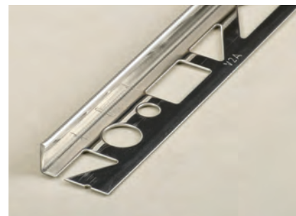
Winkelprofil Edelstahl (V2A) gebürstet Belastbar und Zeitlos Profillänge: 2,50 m Profilhöhe: 6, 8 und 10 mm
